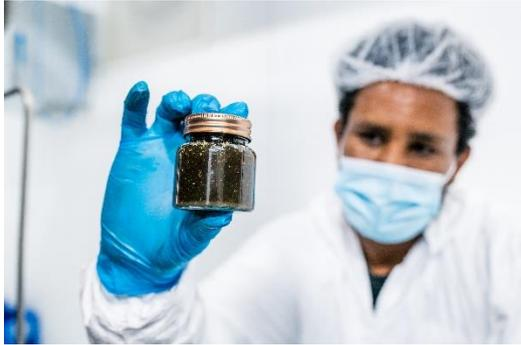
*Aus der PSA gelöste Verunreinigungen durch das Dekontaminationsverfahren mit flüssigem CO<sub>2</sub> (LCO<sub>2</sub>).*
